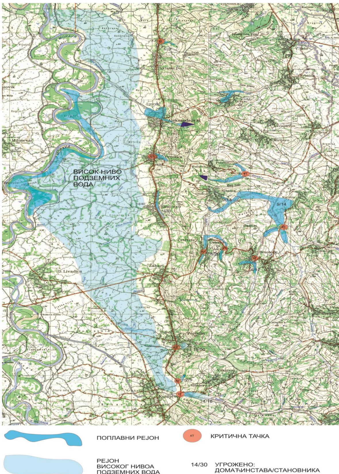
Слика 4. Опасност од поплава на територији Општине Жабари;
