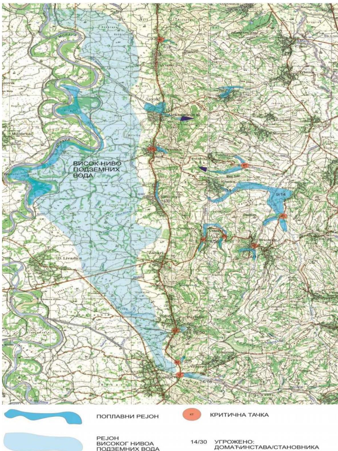
Слика 15. Опасност од поплава на територији Општине Жабари
