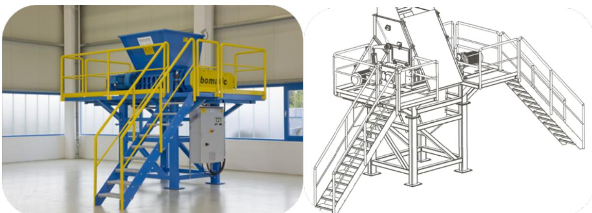
Opis glavnih delova uređaja Bomatic 1200 DD (šreder za gumu) je dat na sledećoj slici.
